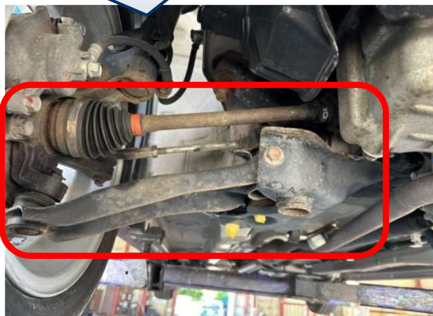
防錆加工をしていない状態例
